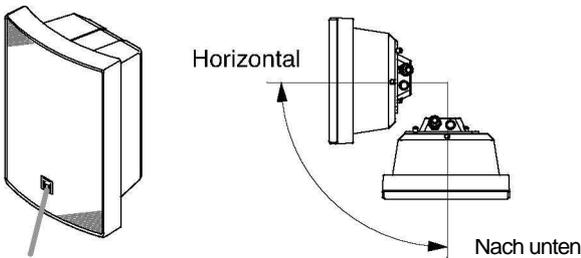
Installieren Sie den Lautsprecher so dass seine Orientierung in diesem Winkelbereich bleibt.
