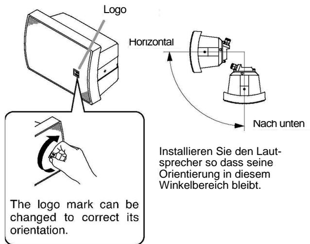
Installieren Sie den Lautsprecher so dass seine Orientierung in diesem Winkelbereich bleibt.
