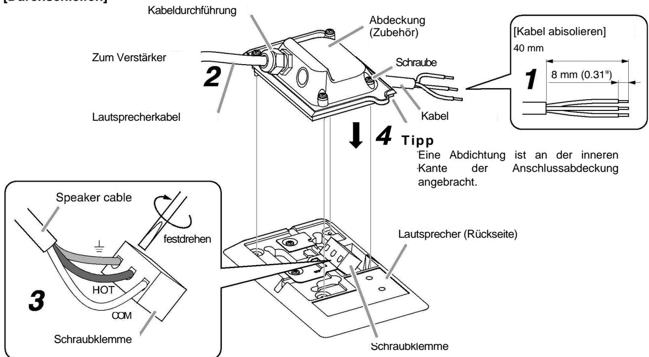
Entfernen Sie die vorgestanzte Ausbrechöffnung an der Abdeckung und montieren die Kabeldurchführung PG 13.5 (optional) an dieser Stelle. Führen sie das Kabel durch die Kabeldurchführung und schließen es an. Achten Sie auf die richtige Polarität
