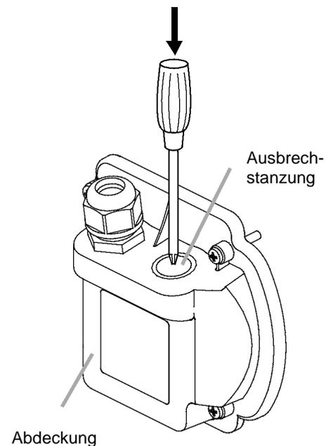
**Schritt 2.** Setzen Sie die Kabeldurchführung ein.
