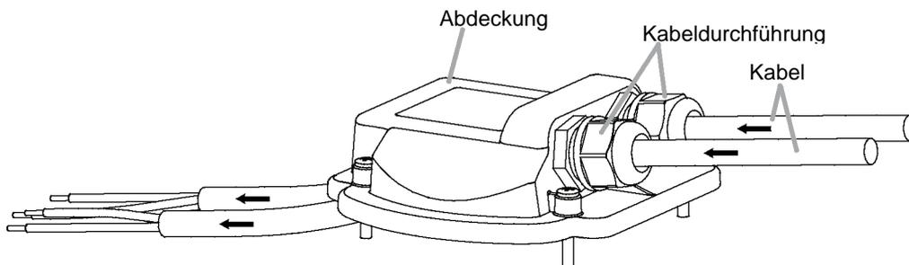
**Schritt 5.** Schließen Sie die Kabel mit der gleichen Polarität an jeden Anschluss, jeweils entsprechend der an den Klemmen angezeigten Polarität.
