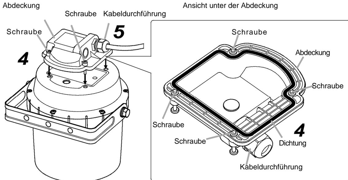
**Schritt 5.** Schrauben Sie die Kabeldurchführung fest.
