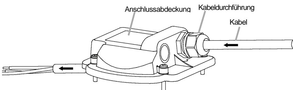
**Schritt 3.** Schließen Sie das Kabel an die Schraubklemme. Polarität beachten!
