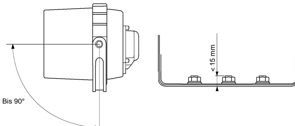
Installieren Sie den Lautsprecher nicht horizontal mit der Lautsprecherfläche nach oben und nicht so dass der Lautsprecherkonus der direkten Einstrahlung durch Sonnenlicht ausgesetzt ist. Sammelt sich Wasser an der Konuskappe oder wird diese durch UV Strahlung geschädigt kann dies zu einer Fehlfunktion des Lautsprechers führen.
