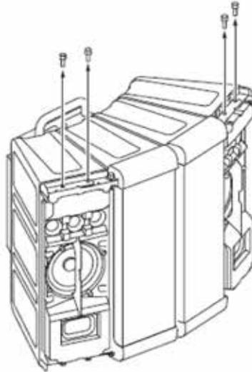
**Schritt 3:** Bringen Sie die Halter an und befestigen Sie diese mit den in Schritt 2 gelösten Bolzen.
