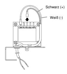
**Schritt 3:** Schließen Sie den Lautsprecher an den Verstärker an. Hierfür muss die Primärwicklung des MT-200 an den Verstärker und die Sekundärwicklung an den Lautsprecher angeschlossen werden. Die Primärwicklung ist wie in Schritt 2 beschrieben gekennzeichnet und die Sekundärwicklung ist mit acht Ohm gekennzeichnet.
